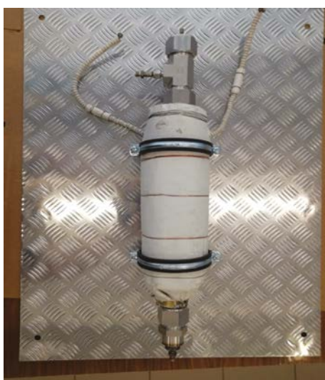
Рис. 1. Лабораторная установка для осуществления процесса пиролиза ПНГ в газовой фазе: а — реактор; б — щит управления
