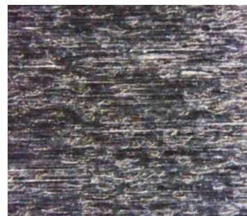
Рис. 5. Снимок обработанной поверхности титана ВТ-6 (увеличение \times 500 )
