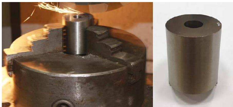
Рис. 4. Процесс обработки заготовки из титана ВТ-6
