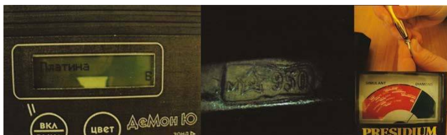
Рис. 2. Экспертиза кольца на приборе PRESIDIUM DUO
