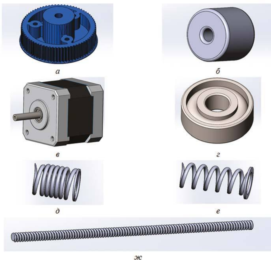
Рис. 2. 3D-модели элементов: а — ведомая шестерня; б — колесо полиуретановое; в — шаговый двигатель; г — подшипник; д — пружина в сжатом состоянии; е — пружина в разжатом состоянии; ж — шпилька резьбовая
