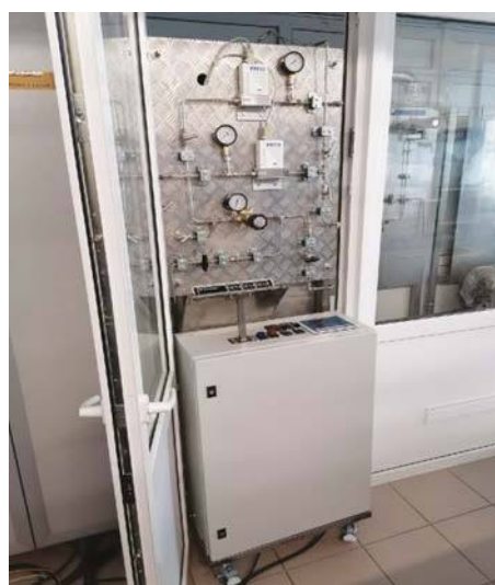
Рис. 1. Лабораторная установка для осуществления процесса пиролиза ПНГ в газовой фазе: а — реактор; б — щит управления
